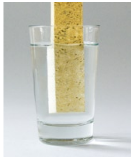
purenit® quillt nicht auf. Selbst nach 10 Tagen im Wasser verändert sich die Materialstruktur nicht.
