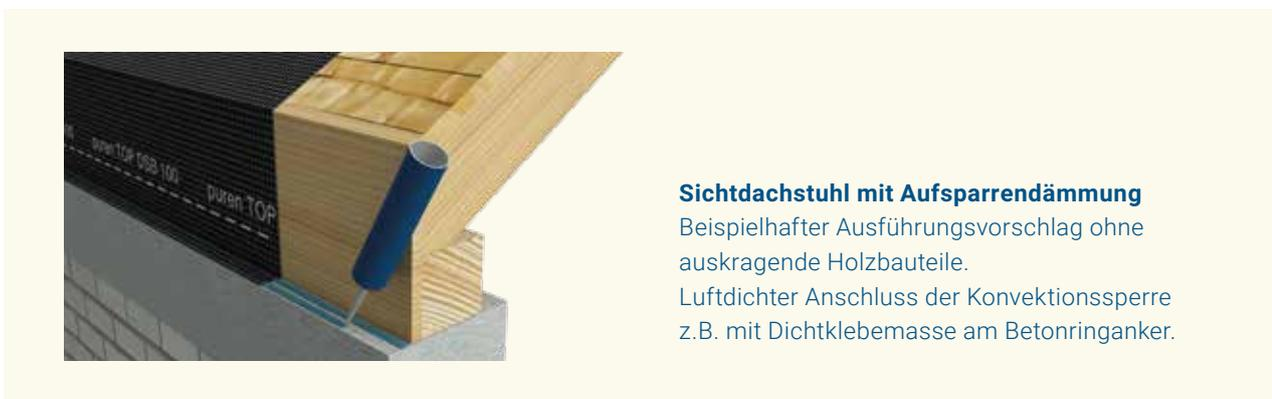
Auskragende Sparren oder Pfetten zur Herstellung der Dachüberstände bilden Durchdringungen der Luftdichtheitsebene, die durch eine allseitige Verklebung des auskragenden Holzquerschnitts mit der Konvektionssperre abgedichtet werden müssen. Dauerelastische Anschlussfugen durchlaufender Holzbauteile an den Innenputz bedürfen der ständigen Kontrolle und Wartung und sind nicht geeignet, die
