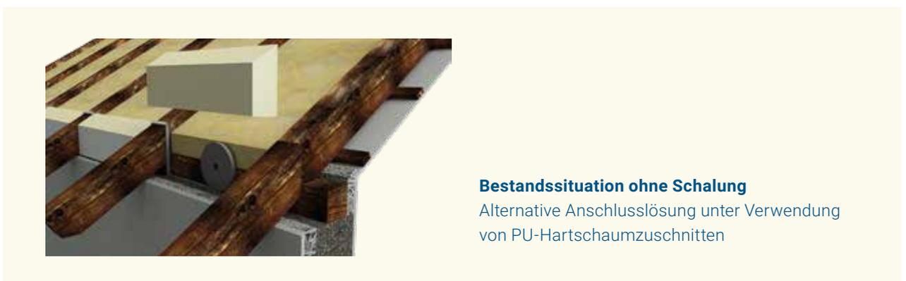
Die Anschlussfugen werden V-förmig ausgebildet und lagenweise mit Montageschaum ausgefüllt. Hierfür empfehlen sich z.B. dauerhaft flexible PU-Montageschäume mit qualifizierter Wärmeleitfähigkeit (WLS 035).
