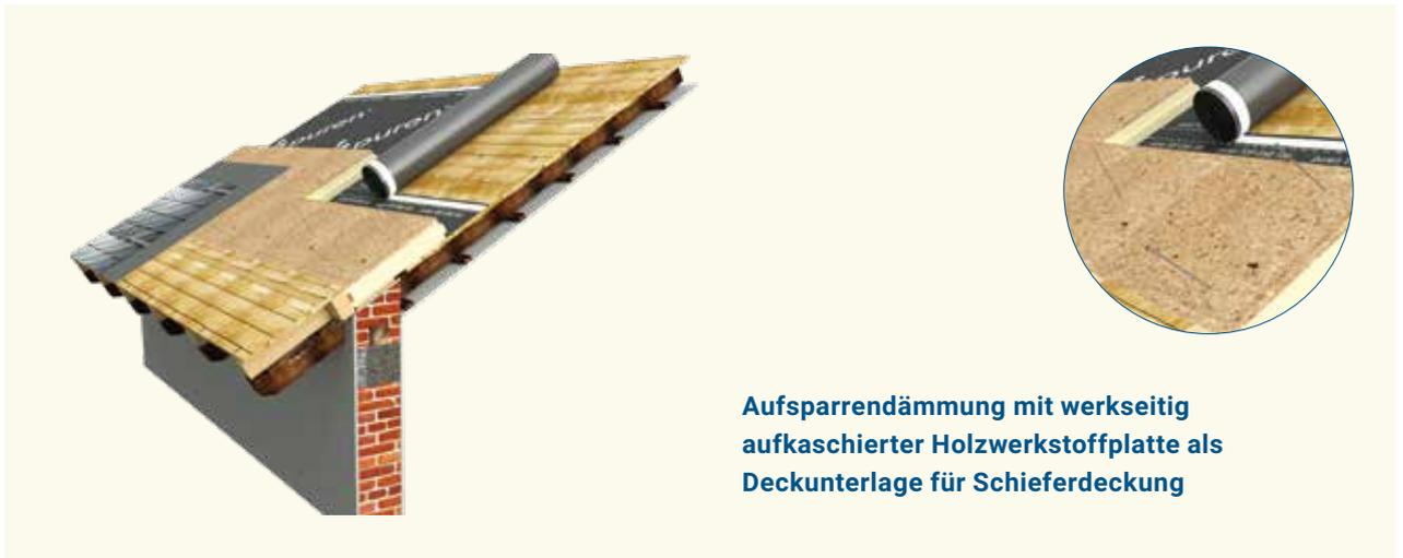
**Aufsparrendämmung mit werkseitig aufkaschierter Holzwerkstoffplatte als Deckunterlage für Schieferdeckung**
