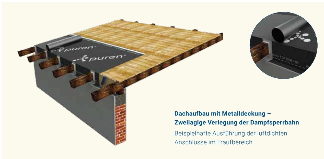
Die Trennlage (Dampfbremse) wird auf der Schalung verlegt, im Überlappungsbereich mechanisch befestigt und in den Stößen verklebt. Die Dampfbremse ist wesentlich geschmeidiger und klebefreundlicher als eine Bitumenbahn und bietet sich daher für die Ausführung der luftdichten Baukörperanschlüsse an. Ein  $s_d$ -Wert  $\geq 100$  m ist für kleinteilige Anschlussbereiche ausreichend.
