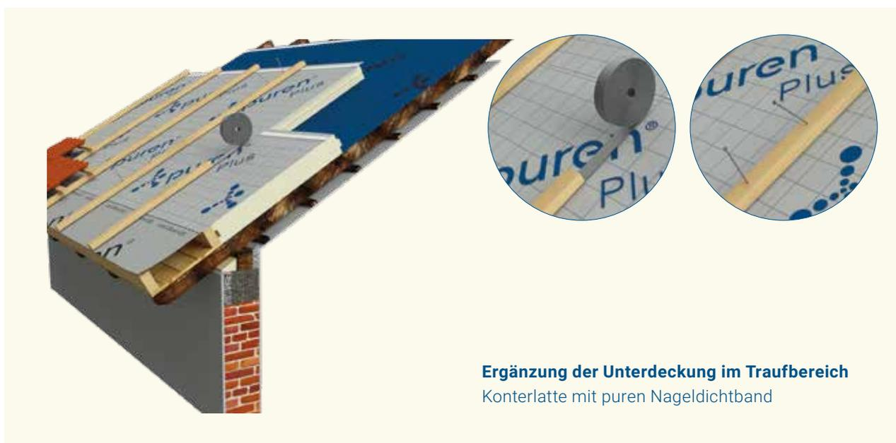
An First, Kehlen, Graten und Anschlüssen (z.B. an aufgehende Bauteile) wird die lückenlose Leckwasserführung durch Überkleben mit einem Streifen aus dem Material der Unterdeckung (z.B. **puren Diffucell-First- und Gratband** oder **puren High-Tech First- und Gratstreifen**) hergestellt.
