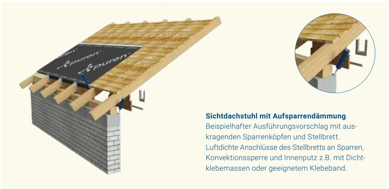
**Sichtdachstuhl mit Aufsparrendämmung.**
