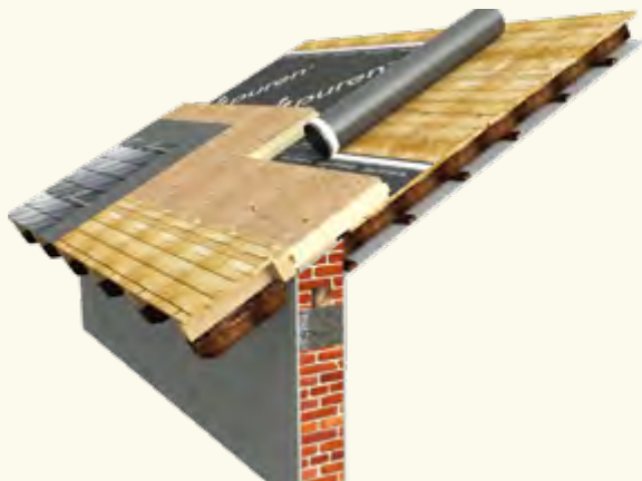
Aufsparrendämmung mit werkseitig aufkaschierter Holzwerkstoffplatte als Deckunterlage für Schieferdeckung
