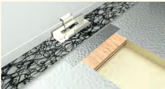
Verlegung der strukturierten Trennlage und Blecheindeckung
