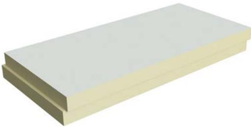
Der umlaufende Stufenfalz sorgt für einen geschlossenen Verbund der Dämmschicht in der Fläche und ermöglicht die einlagige Verlegung. Ebenso eignet sich puren FD-L hervorragend als Grunddämmung in Verbindung mit einer puren Gefälledämmung.
