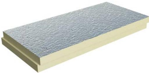
Der umlaufende Stufenfalz sorgt für einen geschlossenen Verbund der Dämmschicht in der Fläche und ermöglicht die einlagige Verlegung. Sehr gut eignet sich puren FD-L auch als besonders effiziente Grunddämmung in Verbindung mit einer puren Gefälledämmung.
