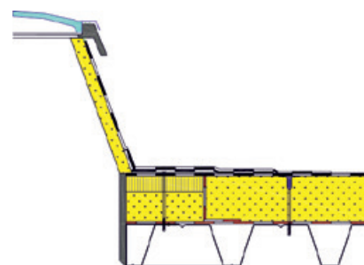
15. ábra: Felülvilágító rögzítése Purenit-tel
