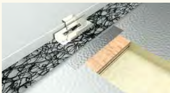
Polaganje strukturirane ločilne plasti in pločevine
