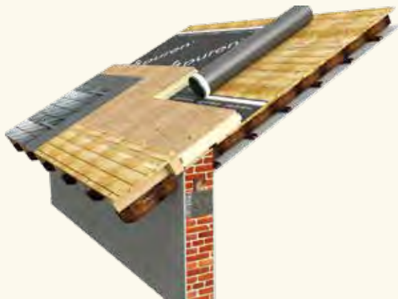
Izolacija nad špirovci s tovarniško nameščeno leseno ploščo kot podlaga za kritino iz skrilavca
