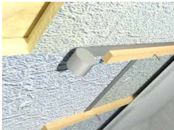
Slika 6. Zrakotesna namestitvev izolacijskih plošč. Pritrjevanje izolacijskih plošč puren Compact z montažnimi profili v špirovce.
