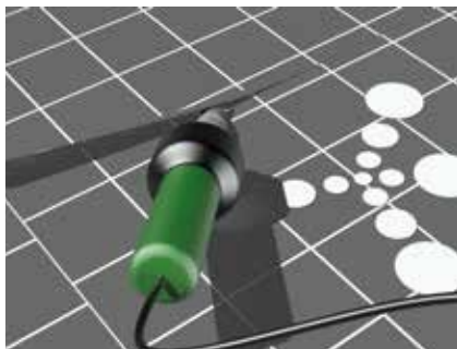
Obr. 40: Svaření spoje horkým vzduchem
