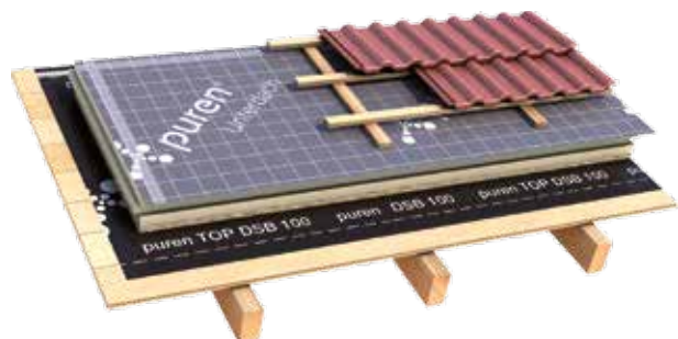
Obr. 4: Skladba puren Spodní střecha na bednění
