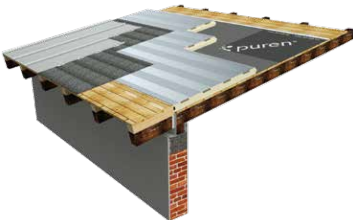
Obr. 48: Pokládka hydroizolační vrstvy a strukturní rohože
