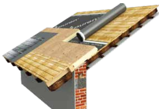
Obr. 45: Pokládka izolační desky puren LivingBoard
