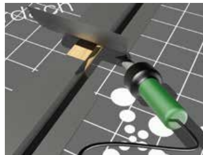
Obr. 42: DHV svařená přes kontralatě
