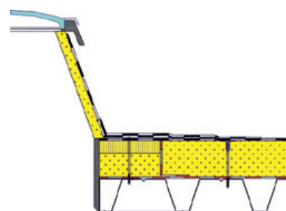
Obr. 19: purenit pro kotvení světlíku
