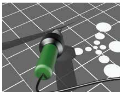
Obr. 40: Svaření spoje horkým vzduchem
