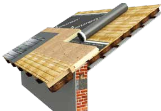
Obr. 45: Pokládka izolační desky puren LivingBoard
