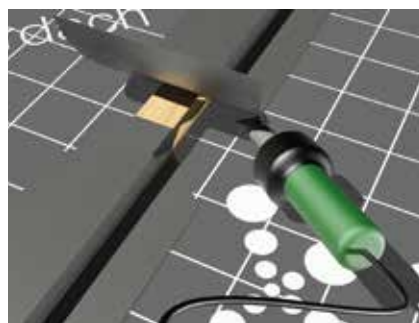
Obr. 42: DHV svařená přes kontralatě
