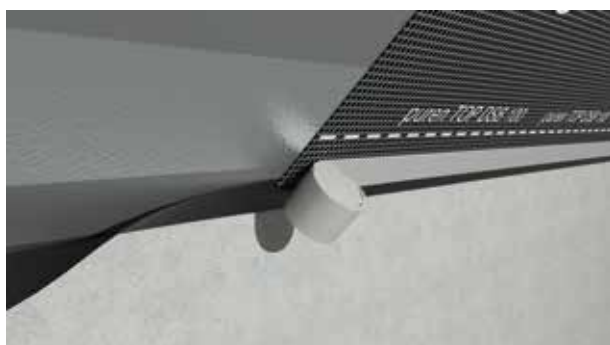
obr.č.10. Izolace pod krokvi se vzduchotěsnou vrstvou na izolačních deskách. Vzduchotěsné spojení parozábrany s vnitřní omítkou pomocí napojovacího lemu např. pomocí lepicího tmelu puren Fix.
