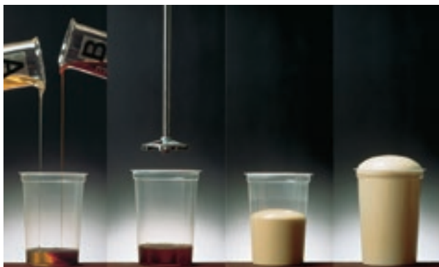
Quatre phases du moussage de mousse rigide polyuréthane
