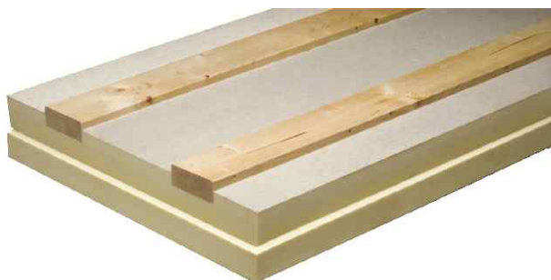
puren HoltaFix mit integrierter Unterkonstruktion und umlaufendem Stufenfalz kann wärmebrückenfrei auf vielen Fassadenuntergründen wirtschaftlich verlegt werden.
